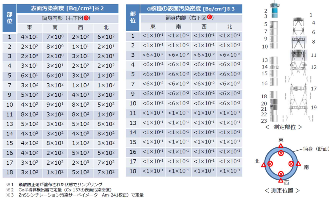
図12 1/2号機共用排気筒 1~18ブロック目解体部材の表面汚染密度の測定結果 (東京電力調査)
