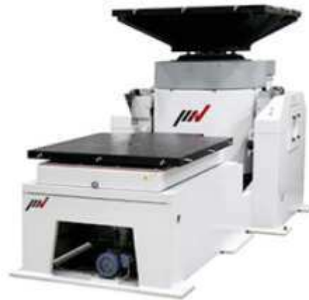
図 5-1 振動台の概要図
