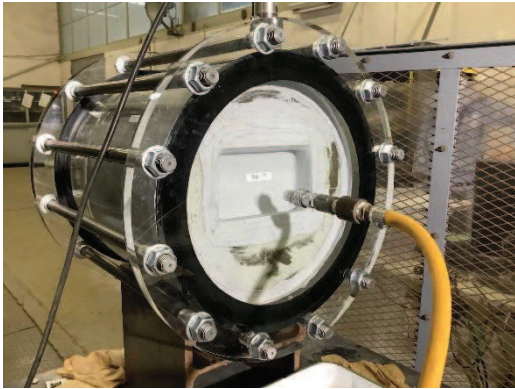
図 6.1.5-17(8) ウレタンシリコーン目地耐圧試験状況 (試験体 No.7) (伸び: 6mm, せん断: 30mm, 水圧 0.28MPa)
