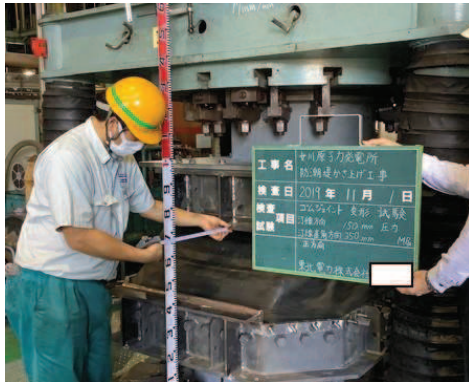
せん断方向距離計測状況
