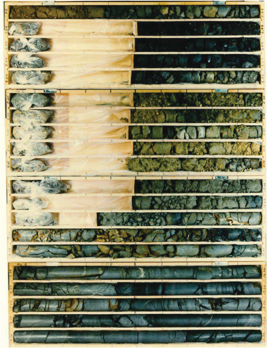
図 1-46(2) ボーリングコア写真 (No. 2) (盛土 : 深度 0~9.90m, 旧表土 : 深度 9.90~11.95m)
