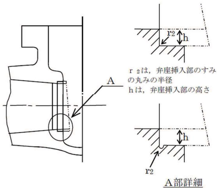
注：本図は設計・建設規格 VVB-3411 の図 VVB-3411-2 と同じ。
