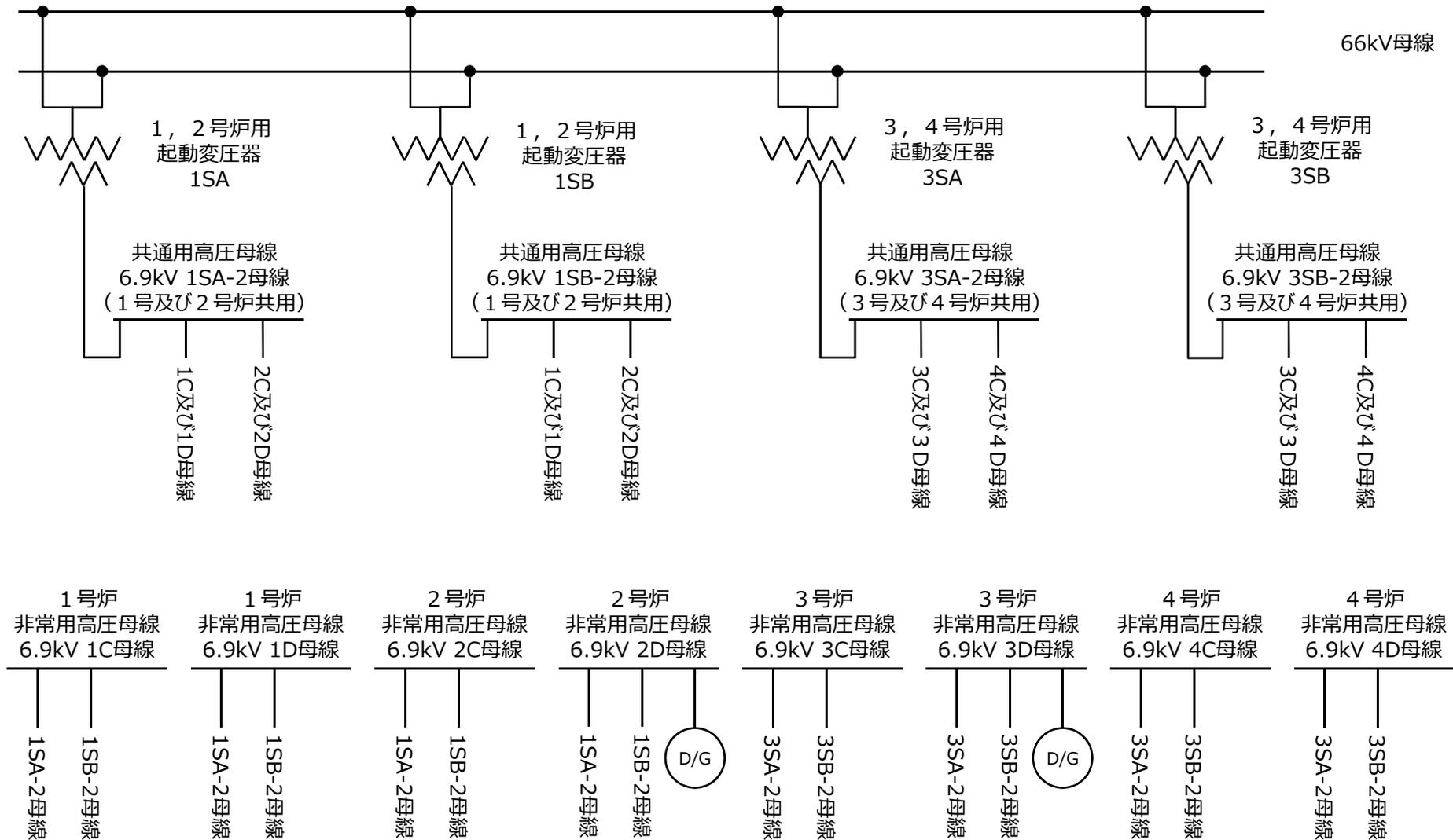
第6-1図 デーゼル発電機から各号炉へ電源を供給する際の電路
