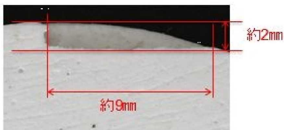
図 1 - 5 減肉試験で取得した減肉形状 (C-SG (X 5 5, Y 3)) (スケールC 4)
