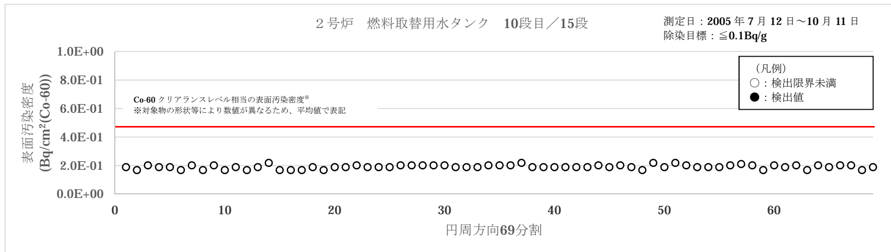
図4 大飯2号炉 燃料取替用水タンク表面汚染密度測定結果 (5/8)
