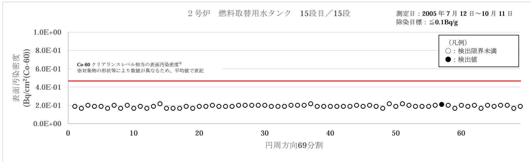
図4 大飯2号炉 燃料取替用水タンク表面汚染密度測定結果 (8/8)
