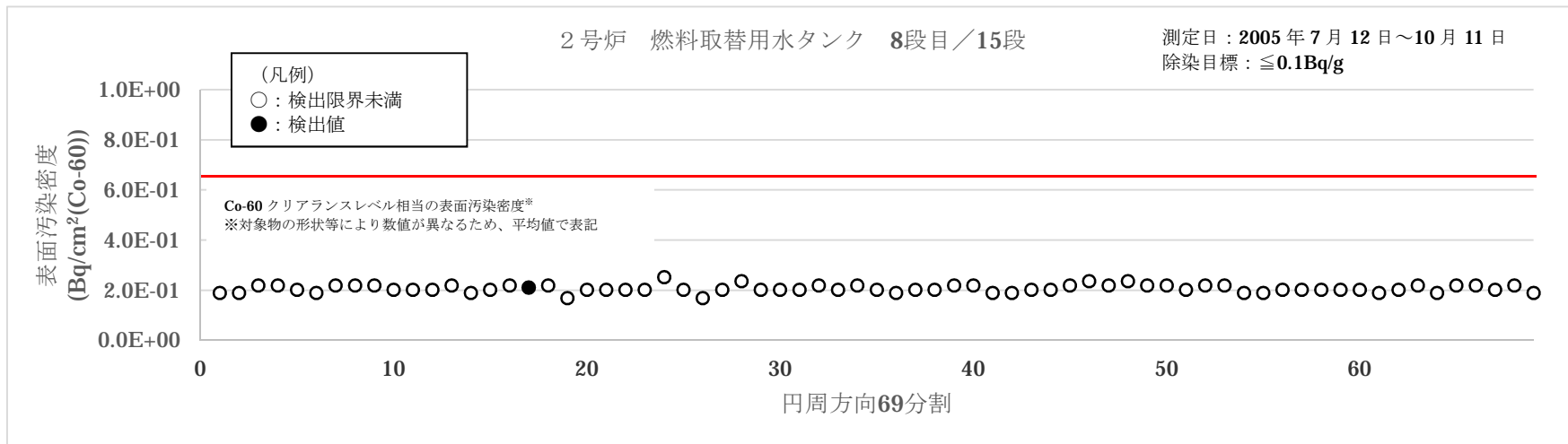
図4 大飯2号炉 燃料取替用水タンク表面汚染密度測定結果 (4/8)
