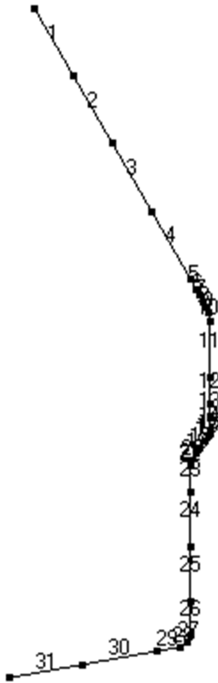
第 3.5 図 貫通部配管 P101(CV 内)の解析モデル図(要素番号)
