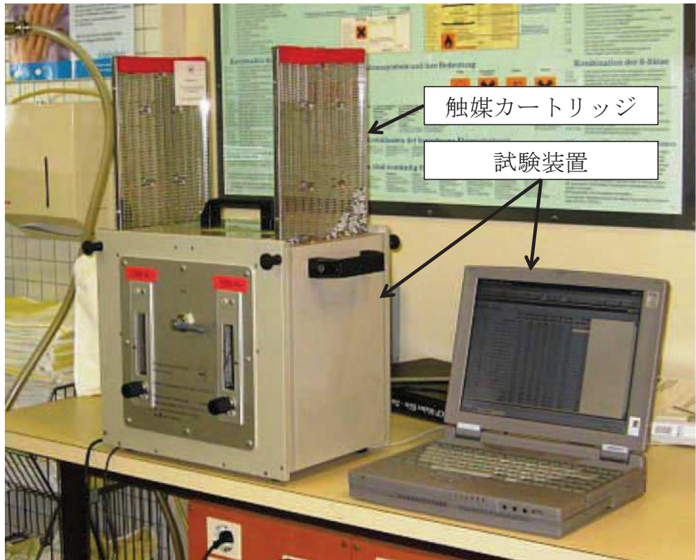
図 4-1 検査装置概要図
