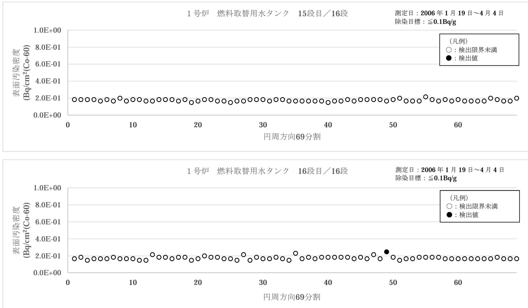
図3 大飯1号炉 燃料取替用水タンク表面汚染密度測定結果 (8/8)
