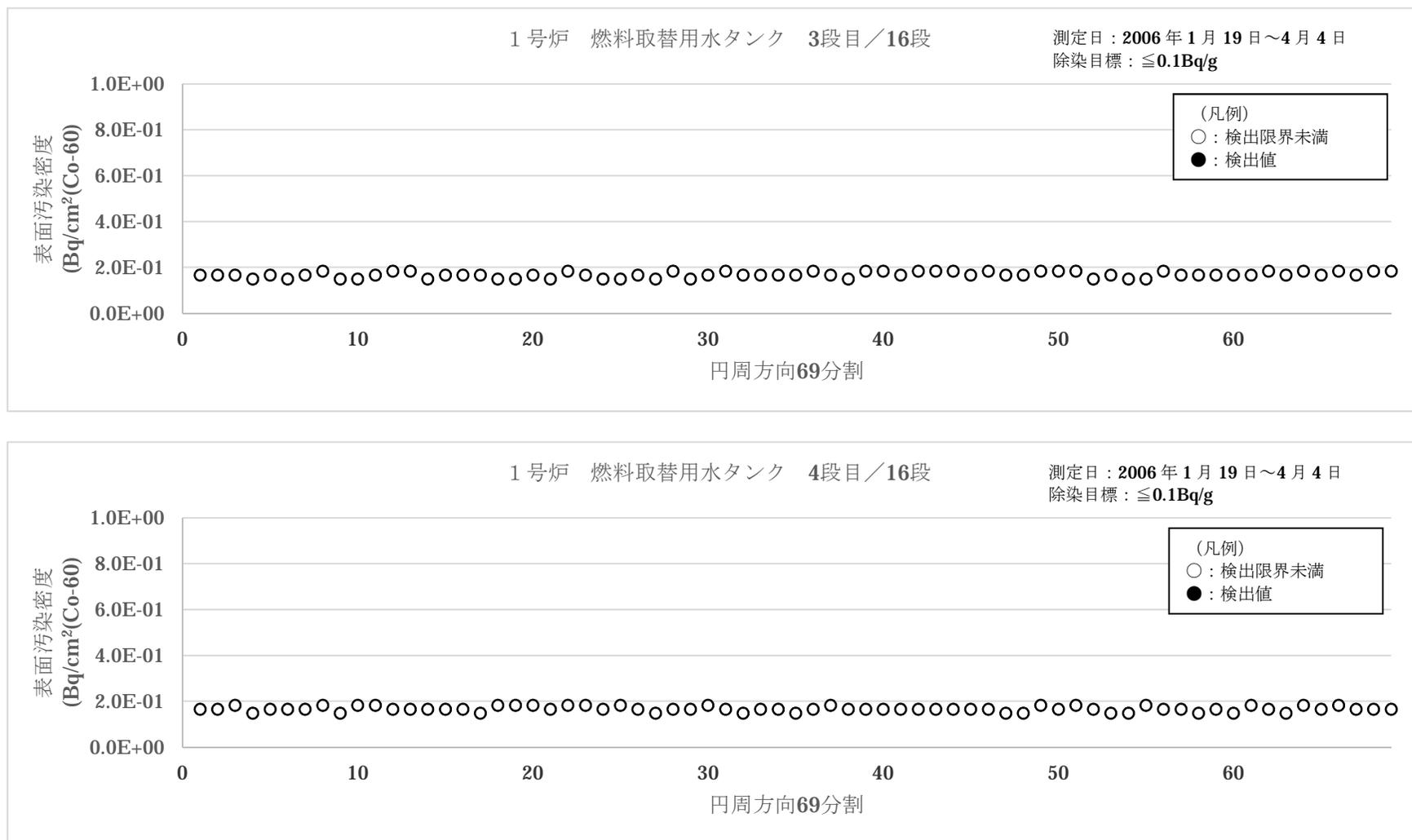
図3 大飯1号炉 燃料取替用水タンク表面汚染密度測定結果 (2/8)
