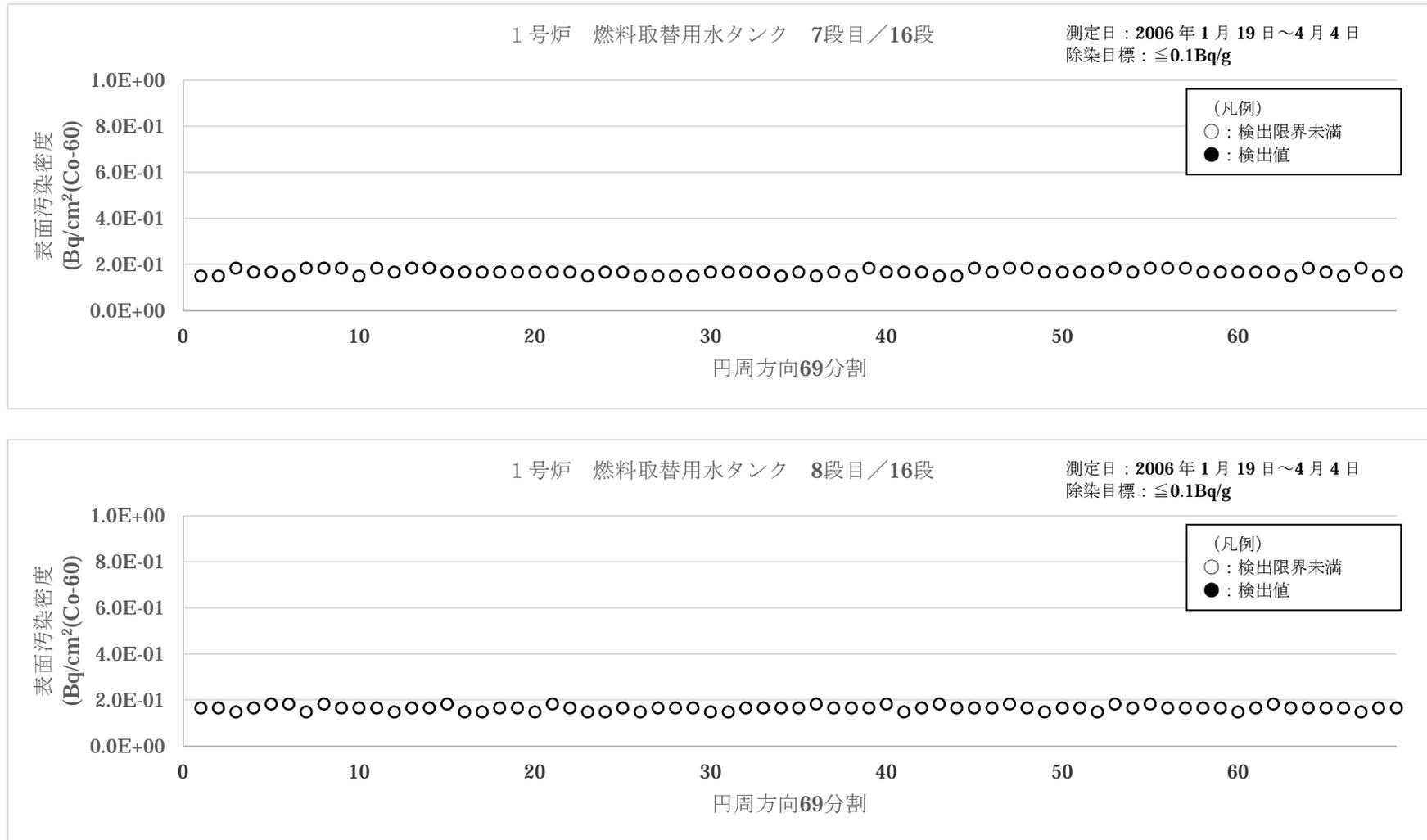
図3 大飯1号炉 燃料取替用水タンク表面汚染密度測定結果 (4/8)
