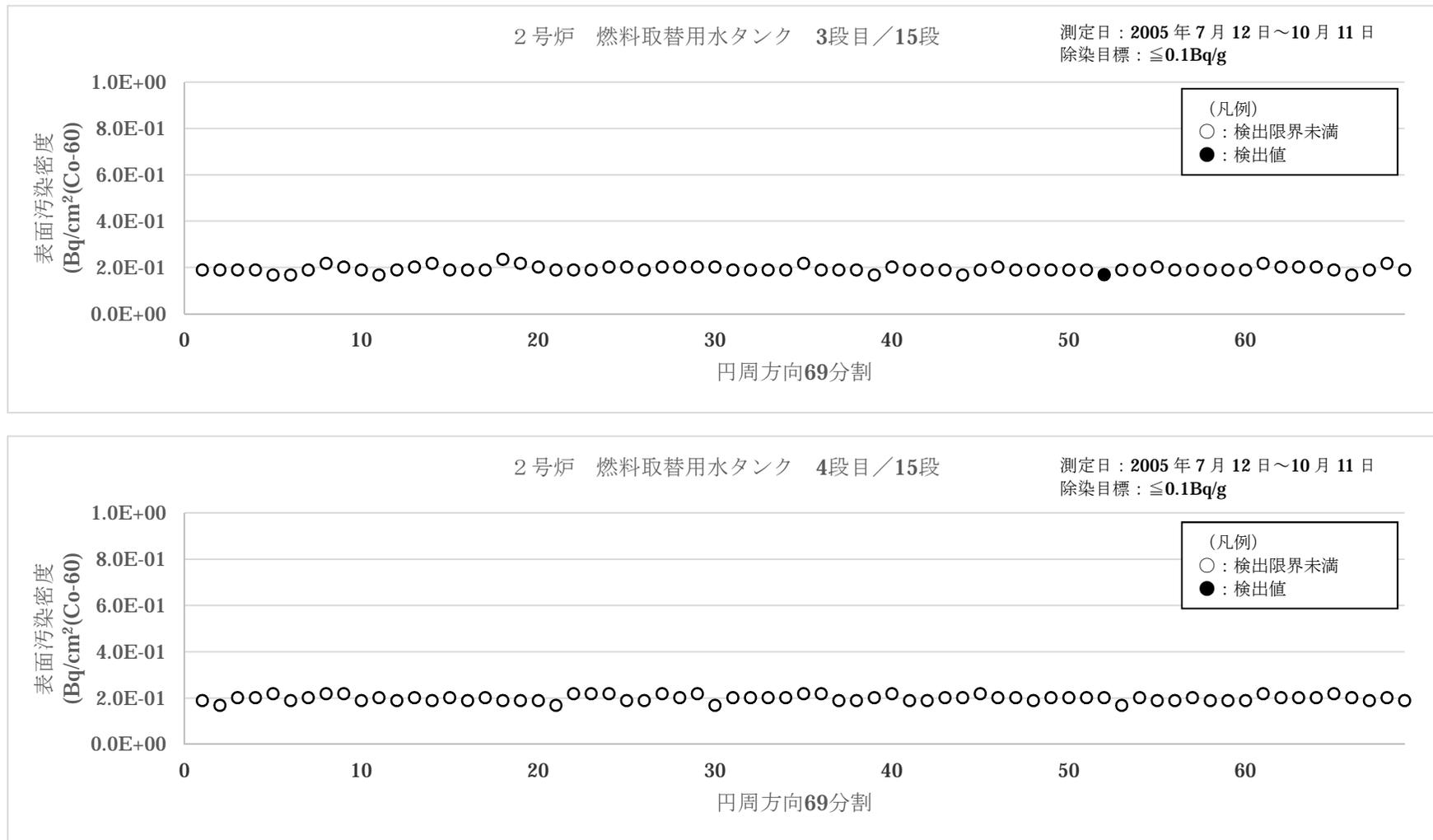
図4 大飯2号炉 燃料取替用水タンク表面汚染密度測定結果 (2/8)
