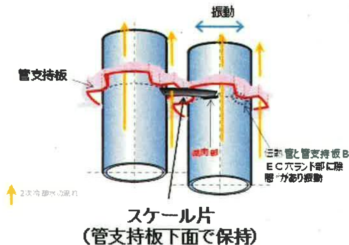
図2 スケール片の接触状態の想定（伝熱管振動ケース）
