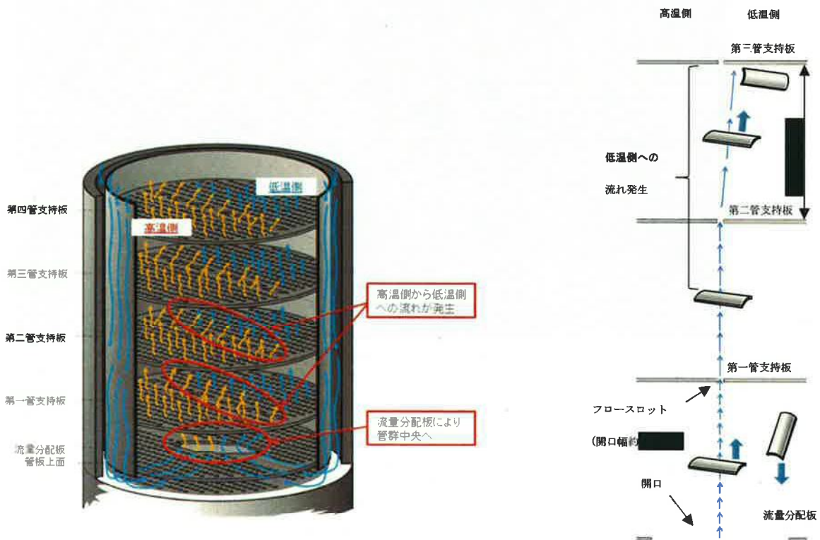
図1 SG 2次側下部の器内流況およびスケール挙動
