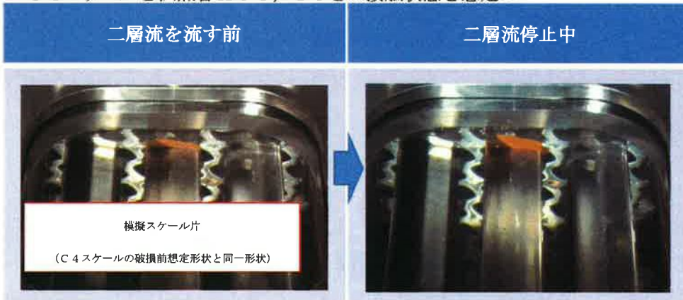
図2 水空気試験結果
