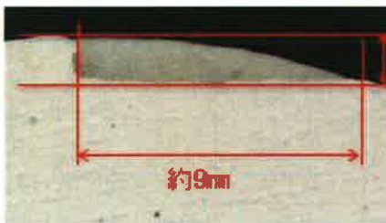
図1-5 減肉試験で取得した減肉形状（C-SG（X55，Y3）） （C4スケール）
