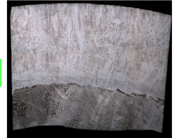
当該管 溶接クレーター部断面組織
