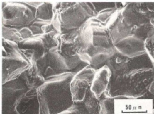
液化割れの例*3
