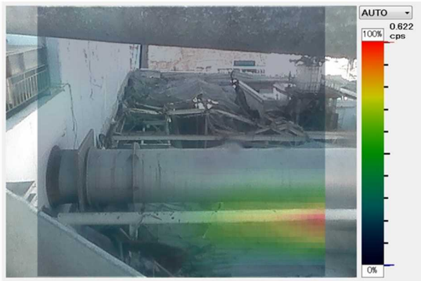
図1-⑤ 2号機SGTS配管の汚染状況（ガンマカメラ）
