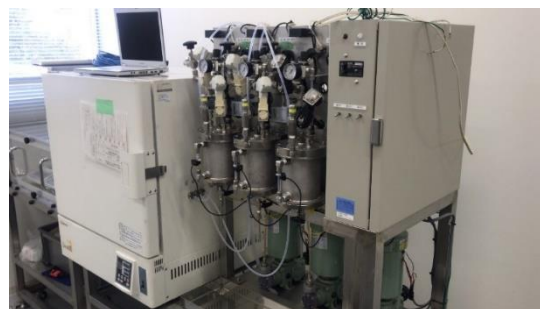
図6 ベントナイト系人工バリアの変質試験に用いる透水試験装置
