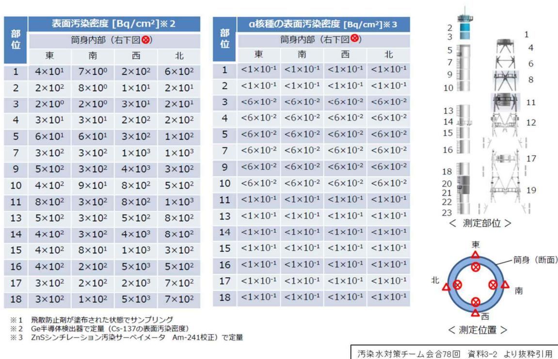
図12 1/2号機共用排気筒 1~18ブロック目解体部材の表面汚染密度の測定結果 (東京電力調査)
