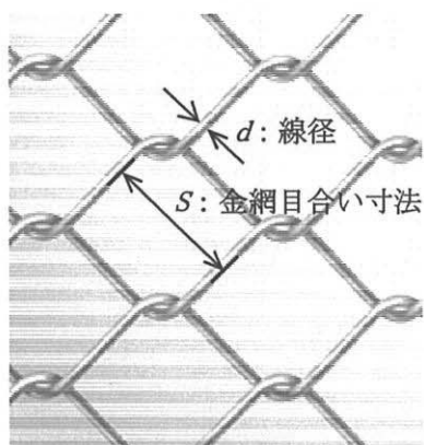
添説建3-X.3.2-1図 金網線径と目合い寸法
