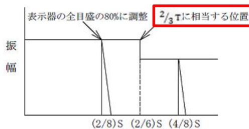
図-4252-1 突合せ溶接継手の基準感度の設定 (縦波斜角法で試験部の厚さが25mm以下の場合) (1) DAC回路を使用しない場合(抜粋)
