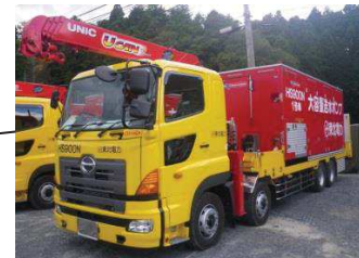
大容量送水ポンプ(タイプI)
