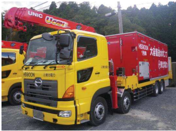
大容量送水ポンプ(タイプ I)
