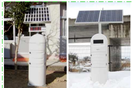
リアルタイム線量測定システム (福島県内 2,981台)
