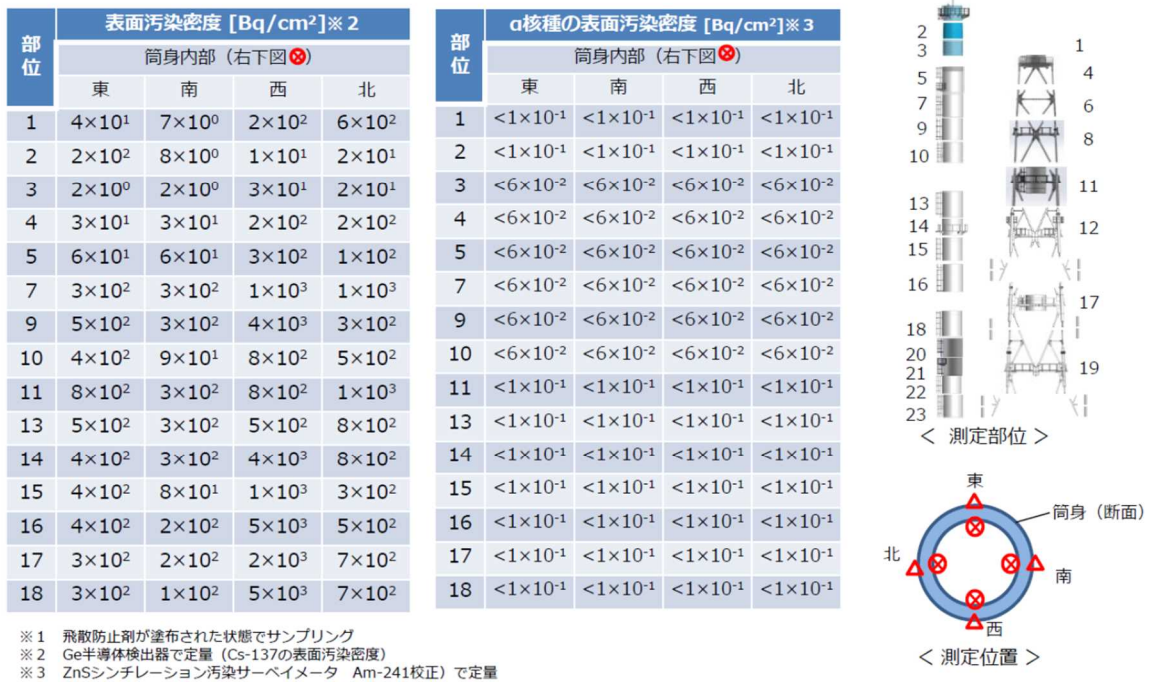
図 1 2 1 / 2号機共用排気筒 1~18ブロック目解体部材の表面汚染密度測定結果 (東京電力調査)
