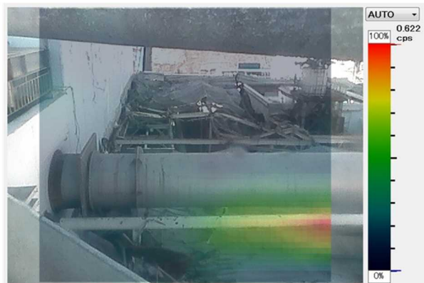
図1-④ 2号機SGTS配管系の汚染状況（ガンマカメラ）
