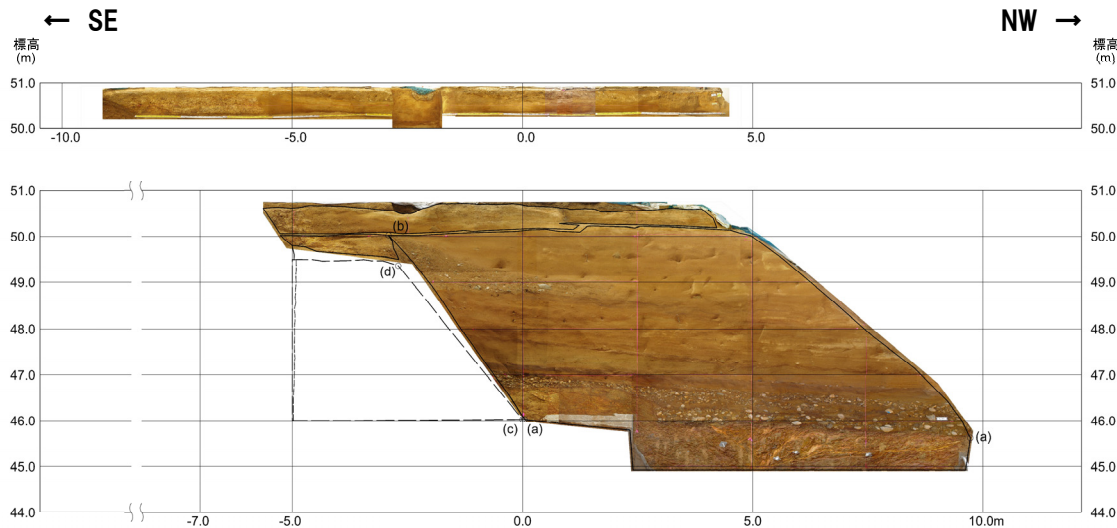
開削調査箇所(南側) 南側壁面の背後法面 壁面写真
