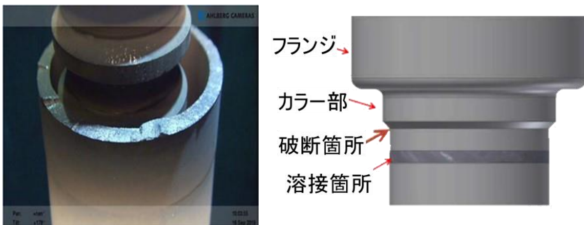
図 4 サーマルスリーブ破断箇所[9]
