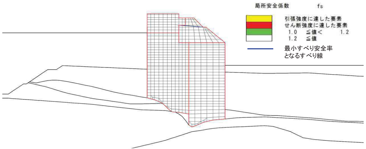
図 4.2-6(2) セメント改良土の最小すべり安全率時刻における局所安全係数分布 (断面②, S d - D 2 (++) , t=25.26s )
