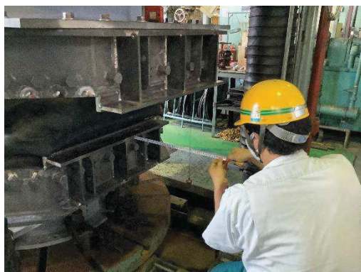
図 6.1.5-10(6) ゴムジョイント変形試験状況 (伸び : 150mm, せん断 : 350mm)
