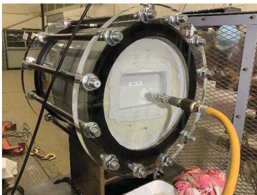
図 6.1.5-13(9) ウレタンシリコーン目地耐圧試験状況（試験体 No.8）
