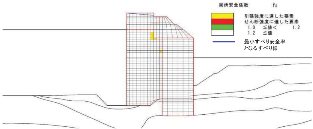
図 4.1-3(1) 背面補強工の局所安全係数分布 (断面①)
