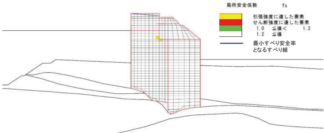
図 4.2-3(2) 背面補強工の最小すべり安全率時刻における局所安全係数分布 (断面②, S d - D 2 (-+), t=16.36s) 解析ケース①: 基本ケース
