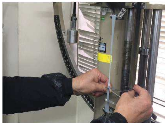
図 6.1.5-21(4) シリコーン材の耐候性試験（引張試験）
