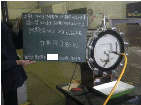
図 6.1.5-13(10) ウレタンシリコン目地耐圧試験結果 (試験体 No. 7)
