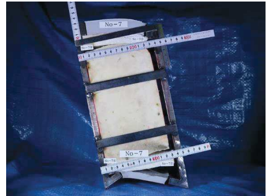
図 6.1.5-13(6) ウレタンシリコン目地変形試験状況 (試験体 No. 7, 伸び 6mm, せん断 30mm)
