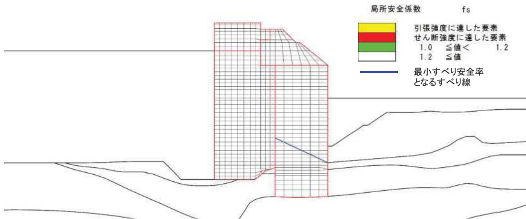
図 4.2-4(1) 置換コンクリートの最小すべり安全率時刻における局所安全係数分布 (断面①, S d - D 2 ( ++ ), t=12.92s) 解析ケース①: 基本ケース
