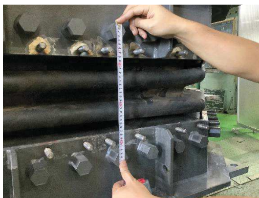
図 6.1.5-10(3) ゴムジョイント設置状況 (枠間距離計測)
