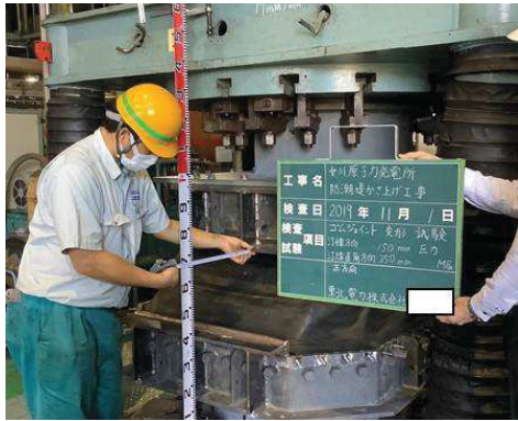
せん断方向距離計測状況
