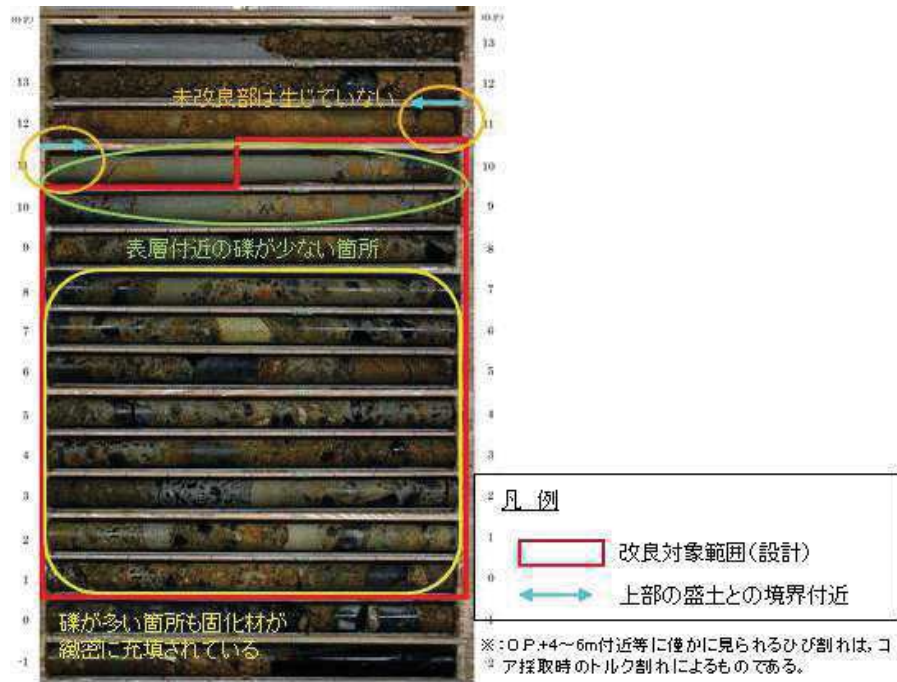
図 6.4-14 ボーリングコア写真 (⑤孔)
