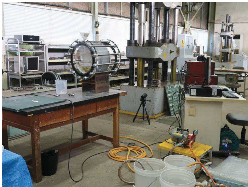
図 6.1.5-13(2) 耐圧試験全体状況
