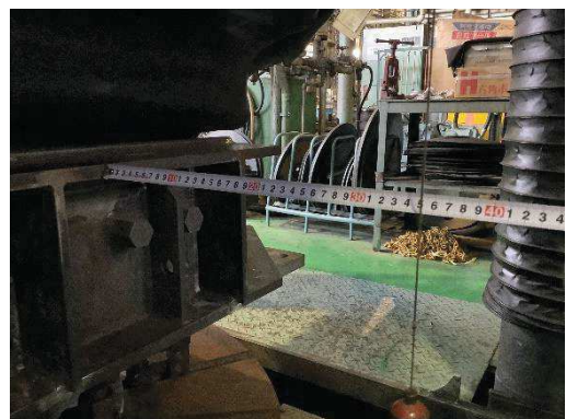
図 6.1.5-10(6) ゴムジョイント変形試験状況 (伸び : 150mm, せん断 : 350mm)
