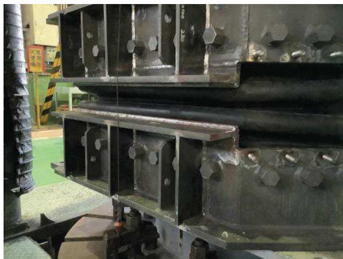
図 6.1.5-10(2) ゴムジョイント設置状況
