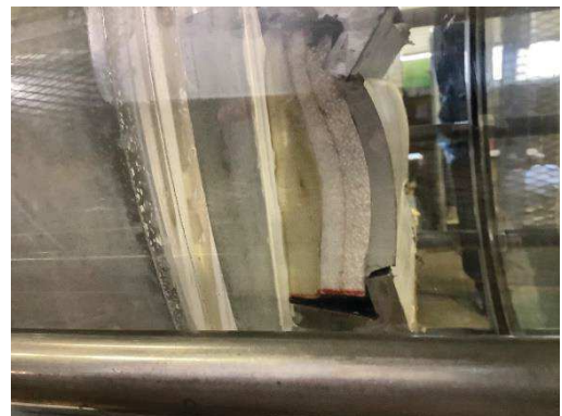
図 6.1.5-13(9) ウレタンシリコーン目地耐圧試験状況（試験体 No.8）
