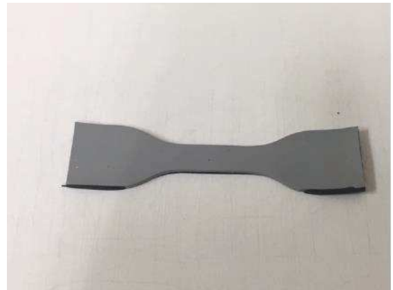
シリコーン材をを2号ダンベルに打ち抜く
