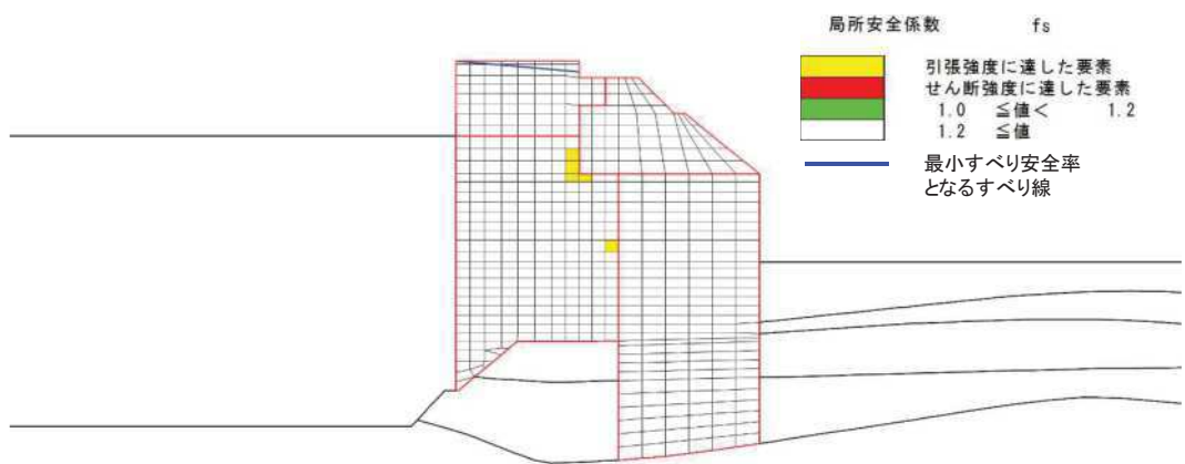
図 4.1-3(3) 背面補強工の局所安全係数分布 (断面③)
