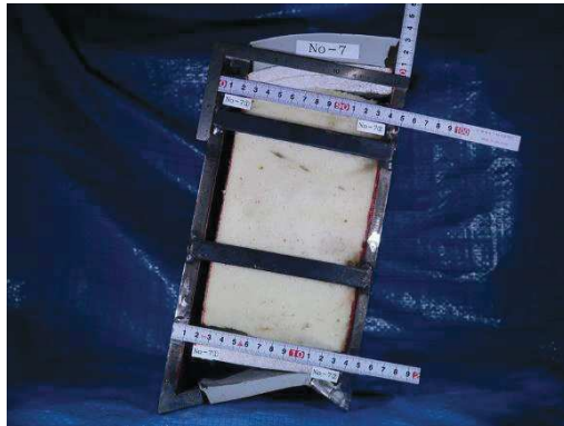
図 6.1.5-13(6) ウレタンシリコン目地変形試験状況 (試験体 No. 7, 伸び 6mm, せん断 30mm)
