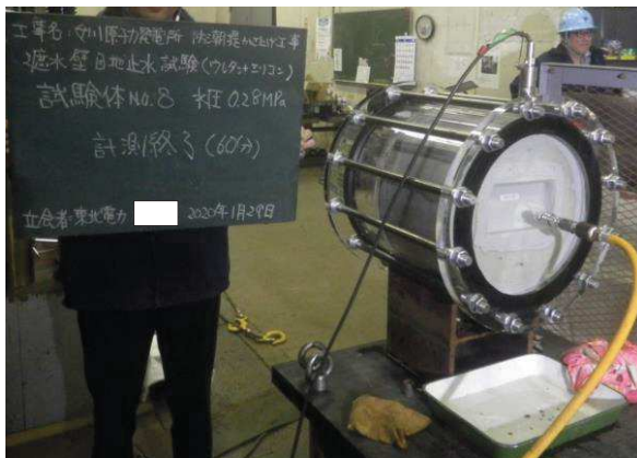
図 6.1.5-13(11) ウレタンシリコン目地耐圧試験結果 (試験体 No. 8)
