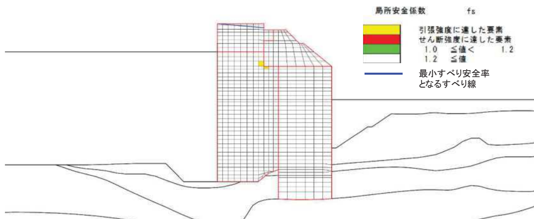
図 4.2-3(1) 背面補強工の最小すべり安全率時刻における局所安全係数分布 (断面①, S d - D 2 (-+), t=17.47s)
