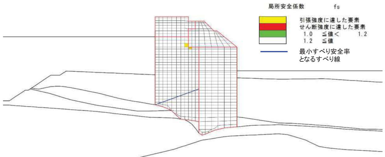
図 4.2-5(2) 改良地盤の最小すべり安全率時刻における局所安全係数分布 (断面②, S d - D 2 (+ -), t=25.49s) 解析ケース①: 基本ケース
