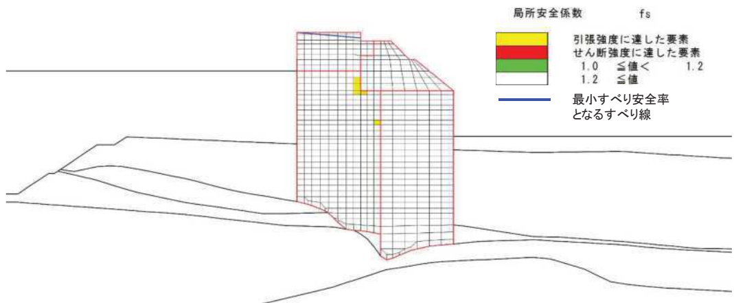
図 4.1-3(2) 背面補強工の局所安全係数分布 (断面②)
