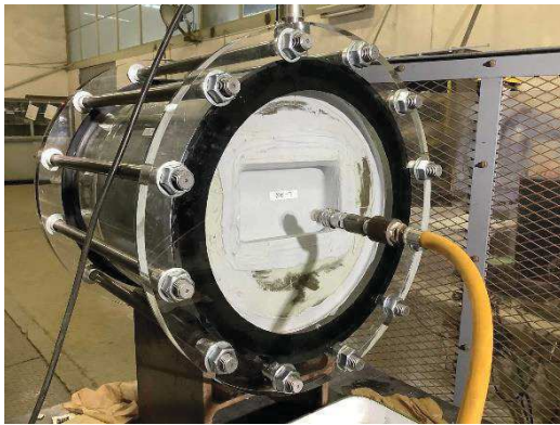
図 6.1.5-13(8) ウレタンシリコーン目地耐圧試験状況（試験体 No.7）
