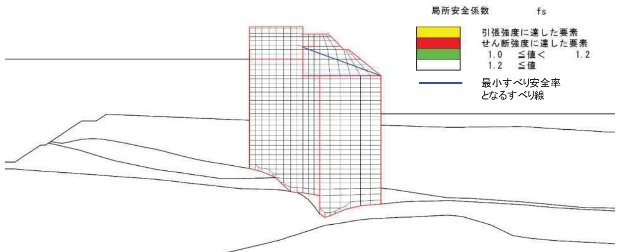
図 4.1-6(2) セメント改良土の局所安全係数分布 (断面②)
