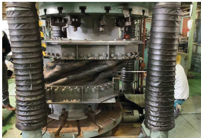
図 6.1.5-10(5) 変形試験全体状況 (伸び 150mm, せん断 350mm, 水圧 0MPa)
