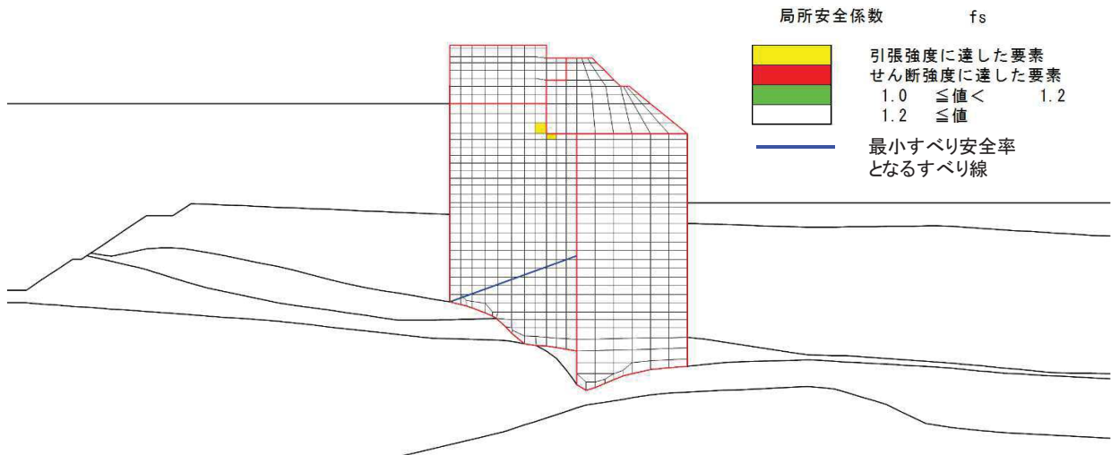
図 5-53 改良地盤の最小すべり安全率時刻における局所安全係数分布 (断面②, S d - D 2 (+-), t=25.49s) 解析ケース①: 基本ケース
