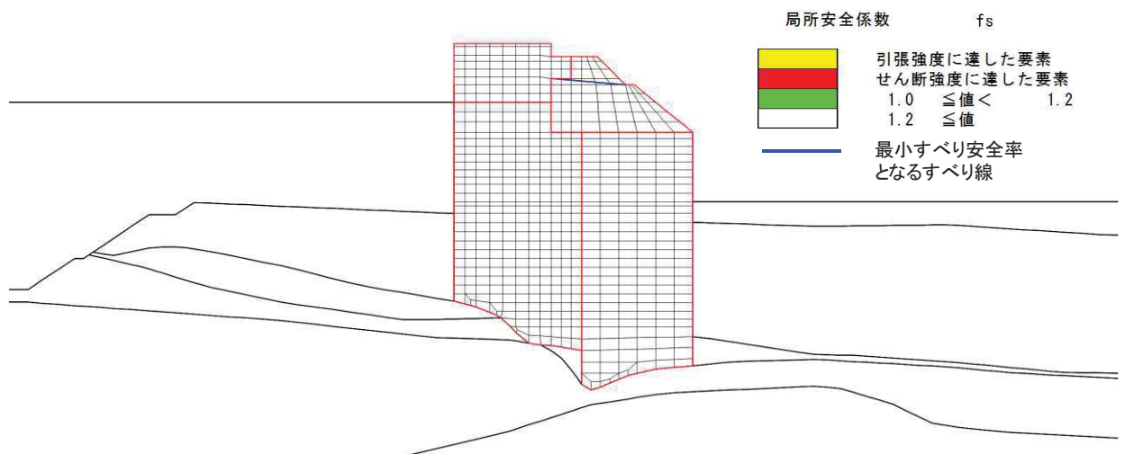
図 5-57 セメント改良土の最小すべり安全率時刻における局所安全係数分布 (断面②, S d - D 2 ( + + ), t=25.26s) 解析ケース③ : 地盤物性のばらつきを考慮した解析ケース (平均値 - 1 σ)
