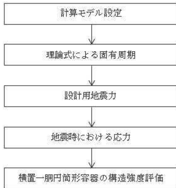
図 2-1 横置一胴円筒形容器の耐震評価フロー
