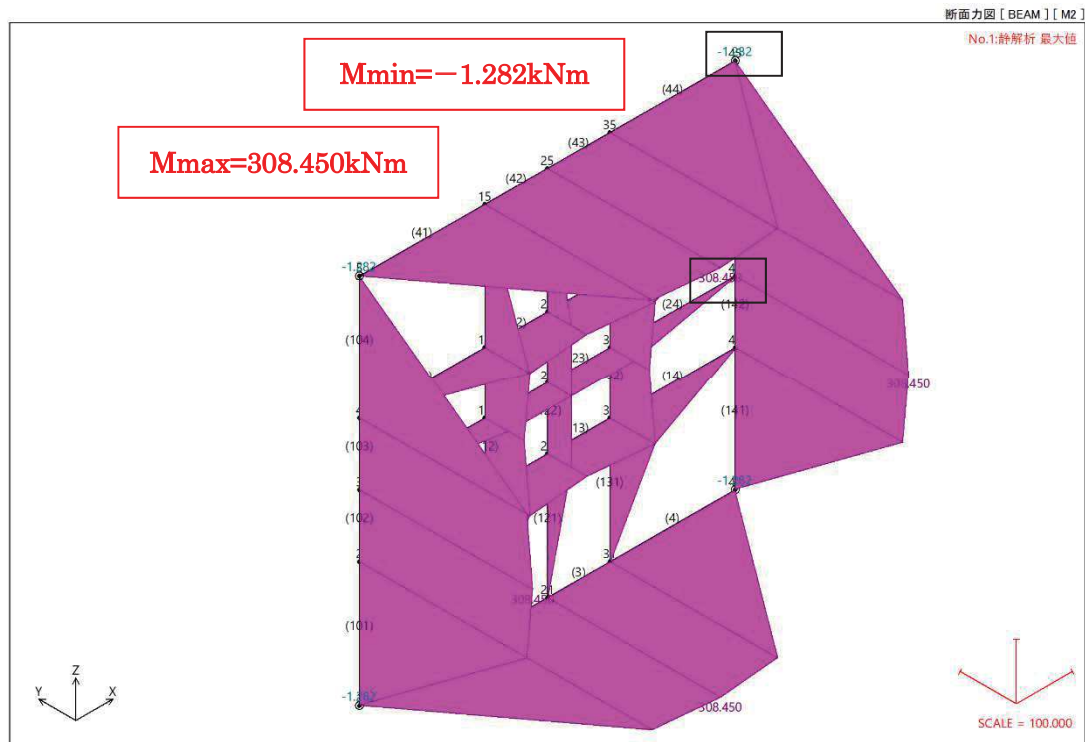
図3-16 TDAPIII 解析結果(曲げモーメント/水平荷重)
