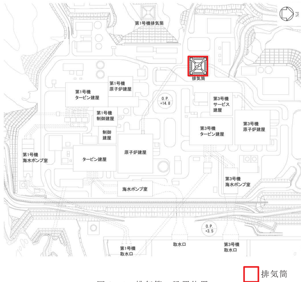
図 2-1 排気筒の設置位置
