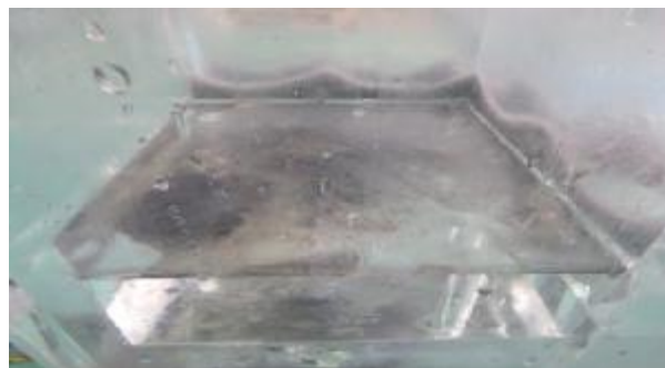
堆積デブリ(水抜き後)
