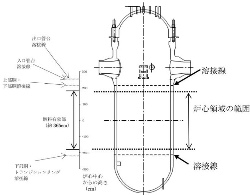
炉心領域上端から溶接線までの距離：約 40 cm
