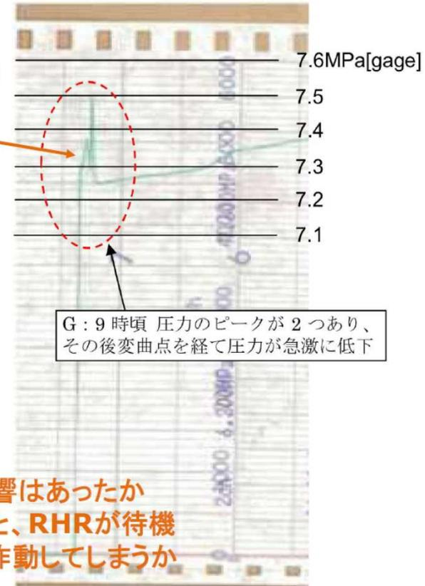
図7 原子炉圧力チャート(狭帯域)
