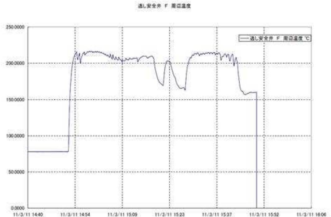
逃がし安全弁の動作状況に応じた温度変化を示している
