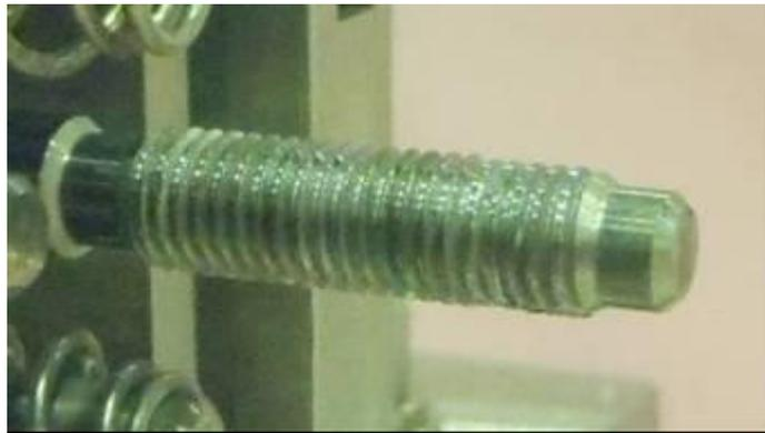
図4-9 4号機新燃料点検結果(結合燃料棒上部端栓)：平成24年8月
