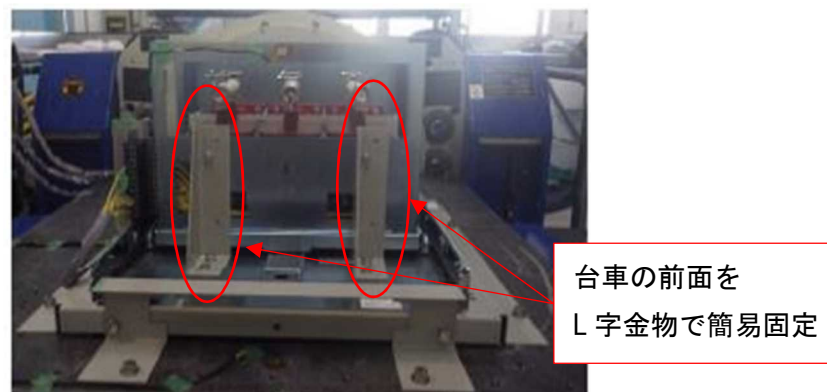
図-4 補強対策を施した試験体
