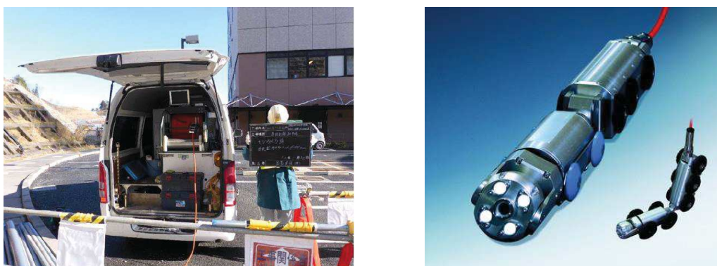
図 3-3-5 自走式 TV カメラの外観イメージ
