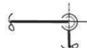
立ち上がり管に取り付く場合 (レジューサの下方が小径端側 のとき)
