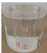
校正用簡易頸部ファントム (PMMA製13cmΦ×12cm)
