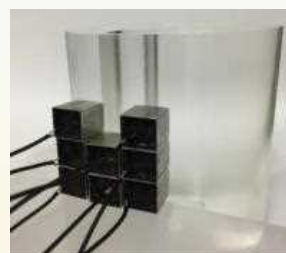
新甲状腺モニタに採用したHR-GAGG検出素子 (※市販品を改良)
