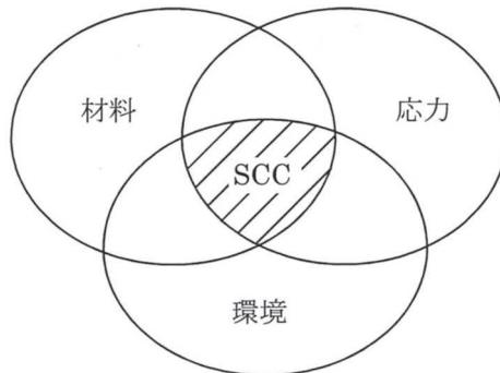
一般的に応力腐食割れを抑制するためには、以下に示すように 3 要因のうちの 1 要因以上を取り除く必要がある。
