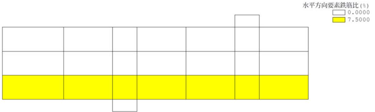
図 5-42 要素鉄筋比 (水平方向)
