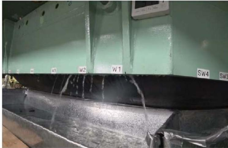
図 2-37 試験時の耐震ジョイントからの漏水状況 (Y=250mm)
