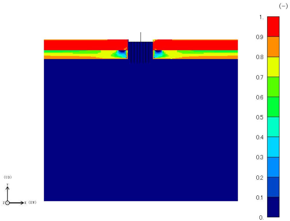
図 3-12 地盤の最大過剰間隙水圧比 (Ss-1, EW 方向)
