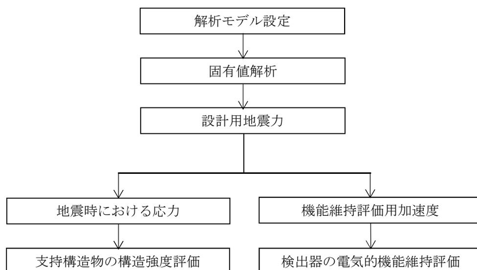
図2-1 耐圧強化ベント系放射線モニタの耐震評価フロー
