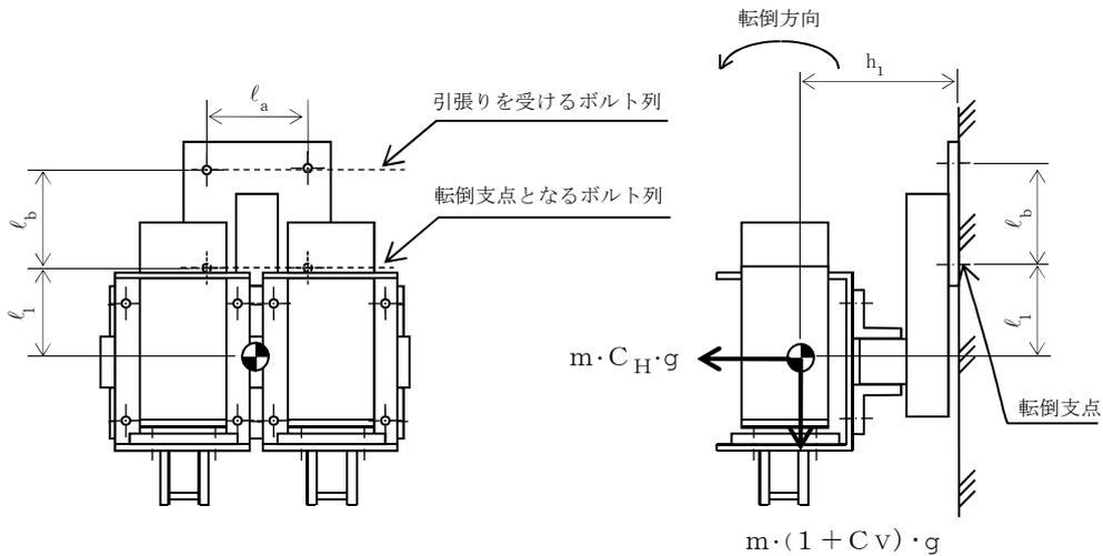
図 5-2 計算モデル（壁掛型 側面方向転倒の場合）
