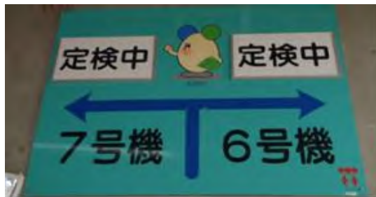
図2-15 現場（管理区域入口）の号機識別（例）
