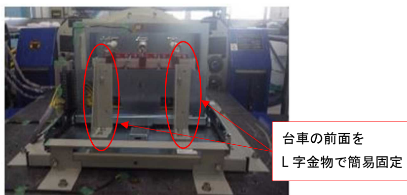
図-4 補強対策を施した試験体
