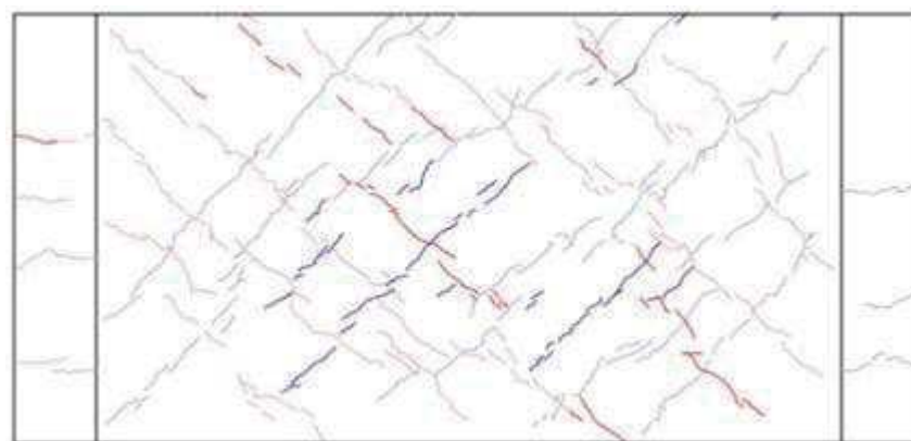
図 3-4 (6) 1/1000rad. におけるひび割れ図
