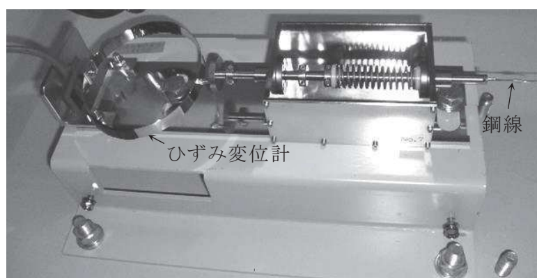
図 1-5 変位計および変位計取付治具の設置状況
