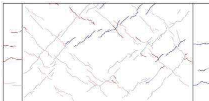
図 3-4 (5) 1/1250rad. におけるひび割れ図
