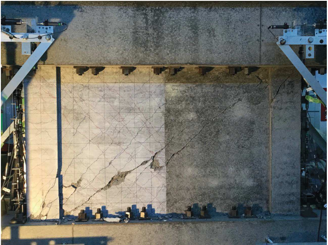
図 2-6 試験体 S-06-D0 最終破壊時写真
