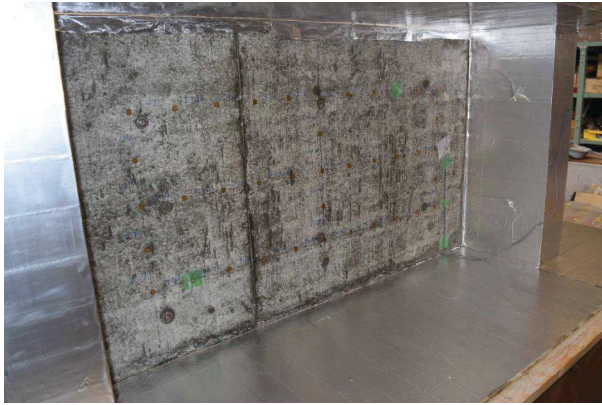
図 2-5 乾燥試験体 [1] [2] 養生状況
