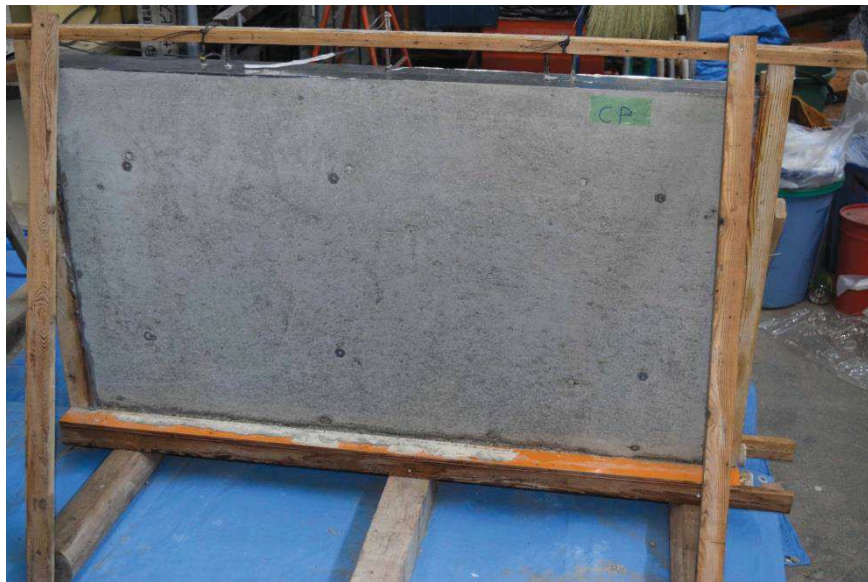
図 2-6 ダミー試験体養生状況
