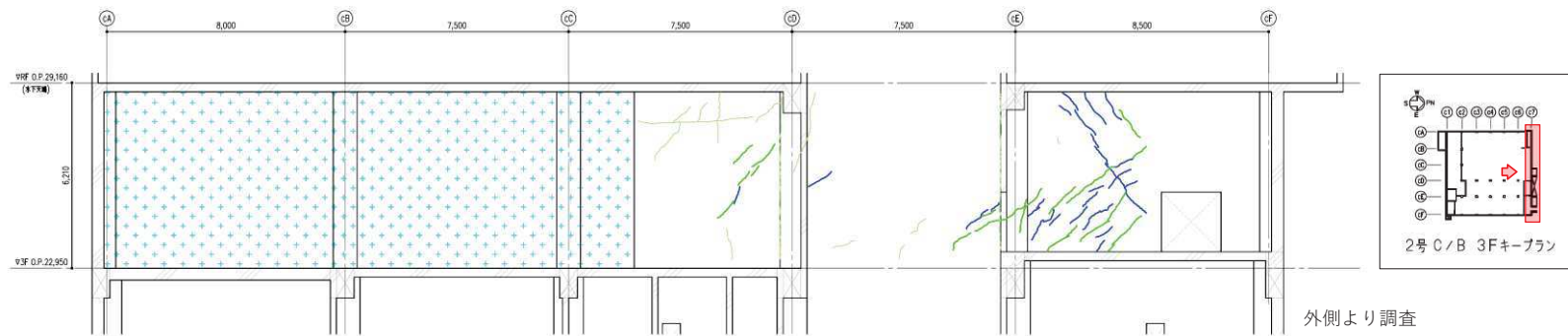
付図-18 制御建屋のひび割れ分布 耐震壁 (18) 3階 C7 通り
