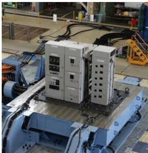
図1-7 過去にNUPEC/JNESで実施した設備の振動試験の一例 (左:電気品、右:大型立形ポンプ)
