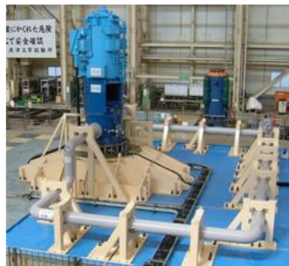
図1-7 過去にNUPEC/JNESで実施した設備の振動試験の一例 (左:電気品、右:大型立形ポンプ)
