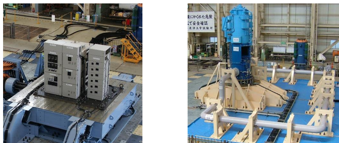
図1-7 過去に旧原子力発電技術機構/原子力安全基盤機構で実施した設備の振動試験の一例 (左：電気品、右：大型立形ポンプ)
