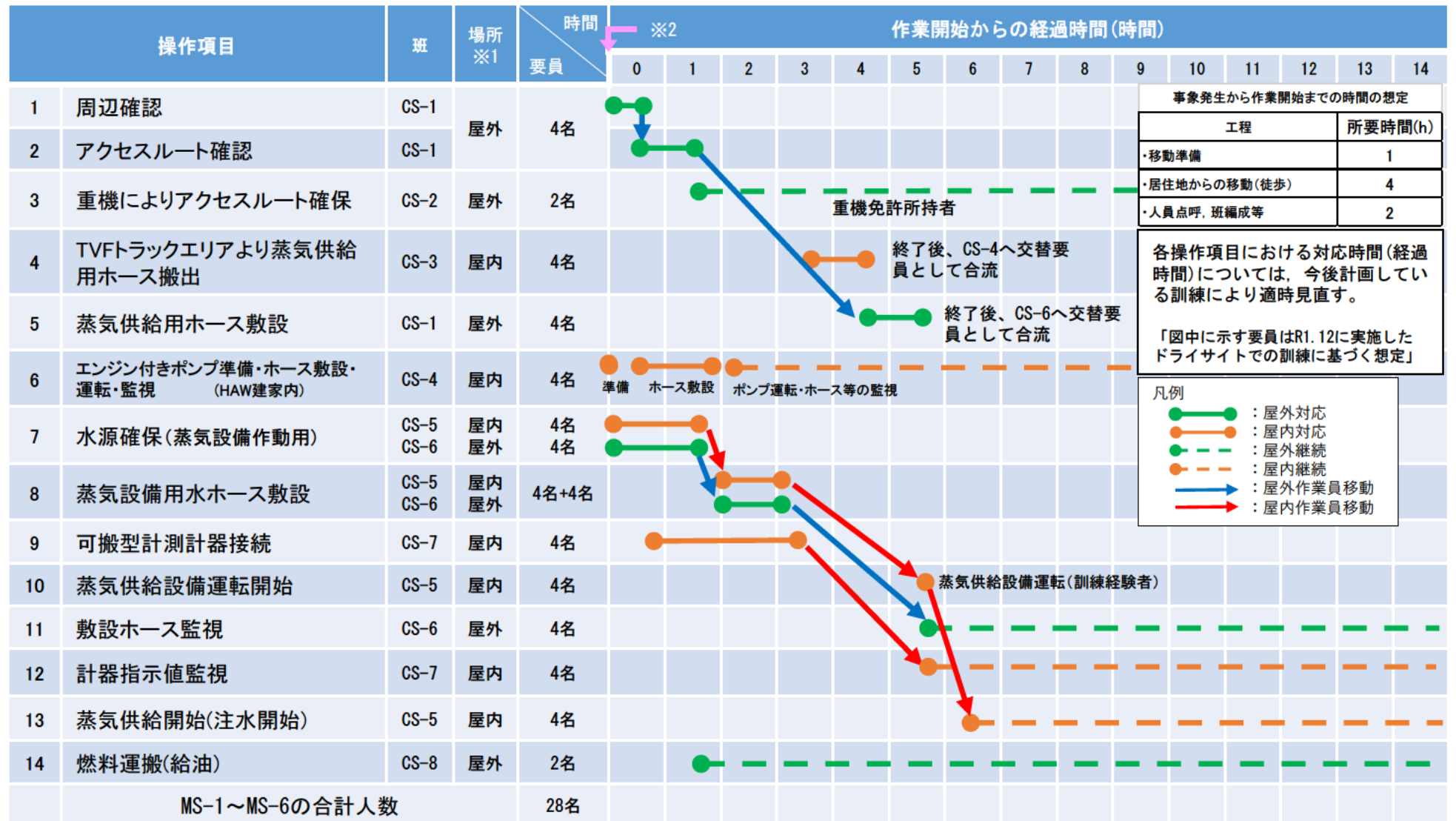
図 1-7-5 「遅延対策」貯槽への直接注水に必要な要員及び作業項目の例（ドライサイト）
